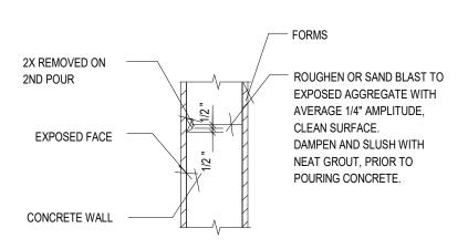
HORIZONTAL POUR JOINT (USED WHERE CONSTRUCTION JOINT WILL BE VISIBLE ON FINISHED SURFACE)
